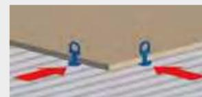
1 Нанесите клеевой раствор и уложите при помощи уровня первую плитку. Установите по два зажима на каждой стороне плитки, отступив от ее края около 50 мм.
