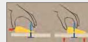
3 Вставьте клин между плитками и верхней частью зажима. Зафиксируйте клин так, чтобы его нижняя часть максимально плотно прилегала к плиткам, добившись выравнивания плиток в плоскости.
